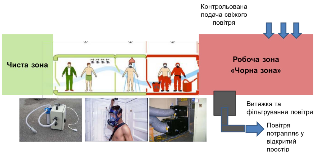
Рисунок 3: Приклад встановлення «чорної зони» та відповідного обладнання
