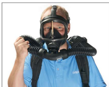
ВИКОНАЙТЕ ВИПРОБУВАННЯ НЕГАТИВНИМ ТИСКОМ З РУКОЮ НА ШЛАНГУ ПОДАЧІ
