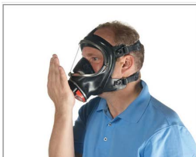
ВИКОНАЙТЕ НЕГАТИВНИЙ ТЕСТ НА ГЕРМЕТИЧНІСТЬ З РУКОЮ НА ФІЛЬТРІ
